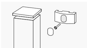
**Poste H:** Para fixação dos painéis na vedação. Inclui tampa, abraçadeira e parafusos auto-perfurantes.
